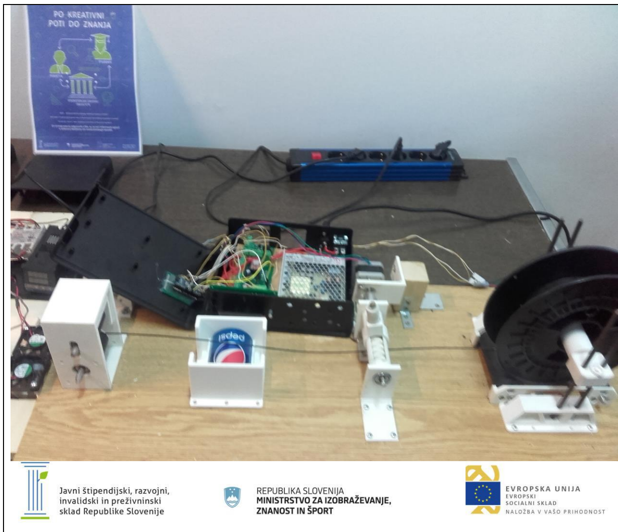
Slika 5: Del prototipa- navijalnik s pripadajočo elektroniko
