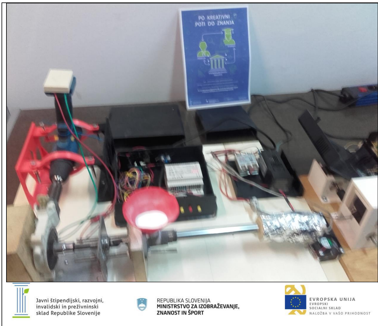
Slika 4: Del prototipa-ekstrudor s pripadajočo elektroniko
